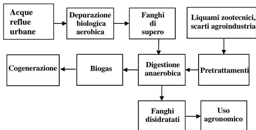
Gli impianti di depurazione di acque reflue urbane dotati di una linea di stabilizzazione fanghi con digestione anaerobica possono essere adeguati per effettuare la codigestione di liquami zootecnici e/o altri scarti agroindustriali, con un importante beneficio energetico (aumento del biogas prodotto) e in alcuni casi anche con un miglioramento dell'efficienza del comparto di denitrificazione che spesso richiede, per un buon funzionamento, una fonte aggiuntiva di carbonio.
